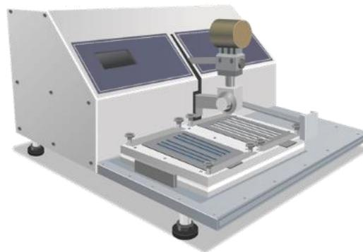
Le test de coupe de la norme EN 388 : 2003, dit Couptest, consiste en un va et vient d'une lame circulaire sur un matériau, sous une force constante (5N soit ~500 g), jusqu'à la coupe. L'essai est réalisé sur l'échantillon de gant comparativement à un matériau témoin en coton et un indice de coupe est calculé :
